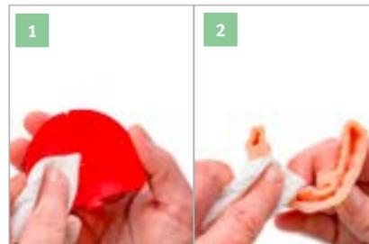
Den **DIVARIO® 3D Oberflächenreiniger** (Art.-Nr. 14600) auf ein sauberes Tuch oder Vlies sprühen und damit die **DIVARIO® Sockelplatte** und die Rückseite des 3D-Druckmodells reinigen.
