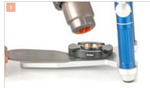
**3** Mit Hilfe eines **Heißluftföns** das Zentrum der **ADESSOSPLIT® Justiersockelplatte** gleichmäßig erhitzen. Nach ca. 30–60 Sek. die Platte vom Artikulatorunterteil mit Hilfe eines Wachs- oder Gipsmessers anlösen. Achtung: Verbrennungsgefahr – ausschließlich auf einem hitzebeständigen Untergrund arbeiten!
