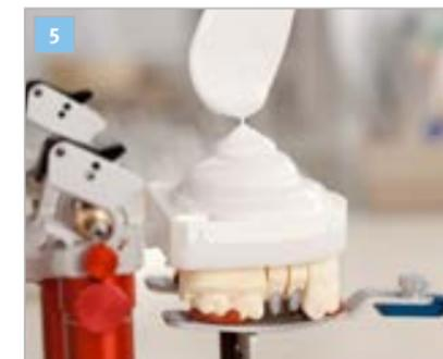
**CORSOART® Artikulator** schließen, um das Platzverhältnis zwischen Modell und **ADESSOSPLIT® Kunststoffartikulationsplatte** zu überprüfen. Artikulationsgips auf das Modell auftragen.
