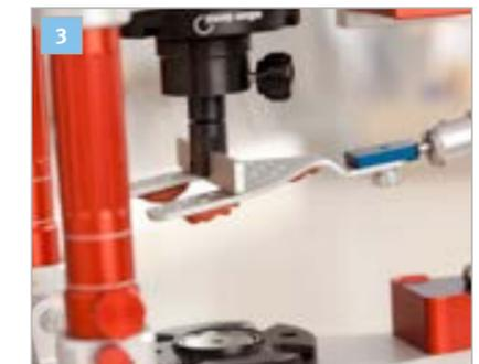
**CORSOART® Artikulator** auf den Kopf stellen und den Quersteg der **CORSOFIX® Bissgabelunterstützung** auf die **CORSOFIX® Bissgabel** fallen lassen. Fixierung der **CORSOFIX® Bissgabelunterstützung** durch Festziehen der Rändelschraube.
