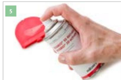
Nun den **DIVARIO® 3D Aktivator** (Art.-Nr. 14603) aus ca. 30 cm Entfernung gleichmäßig und dünn auf die **DIVARIO® Sockelplatte** aufsprühen und ca. 30 Sekunden ablüften lassen, bis die Oberfläche sichtbar matt ist.
