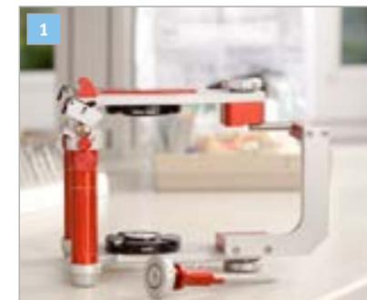
FZR-Stift inklusive Halter entfernen und den FZR-Teller im Artikulatoroberteil einsetzen. Den **CORSOFIX® Übertragungsschlitten** bis zum Anschlag im Artikulatorunterteil einsetzen und festschrauben. Den FZR-Teller nun im Artikulatoroberteil mit der glatten Fläche auf die Stütze des **CORSOFIX® Übertragungsschlittens** auflegen.
