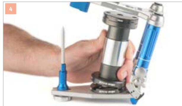
**4** Vor dem Verkleben den **CORSOART® Artikulator** schließen. Die **ADESSOSPLIT® Justiersockelplatte** muss einen Klebespalt von 1–2 mm zum Artikulatorunterteil aufweisen und der Inzisalstift Kontakt zum Frontzahnführungsteller haben.
