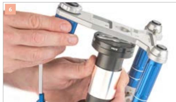
**6** **ADESSOSPLIT® Zentrierschlüssel** leicht nach hinten kippen, um den **CORSOART® Artikulator** zu schließen. Den **ADESSOSPLIT® Metallkleber** anschließend bei geschlossenem **CORSOART® Artikulator** ca. 160 Min. aushärten lassen. Zur Fixierung des **CORSOART® Artikulator** ein Gummiband benutzen. Der Inzisalstift muss dabei auf dem Frontzahnführungsteller aufliegen.
