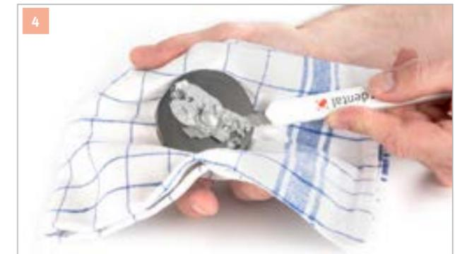
**4** Die Metallkleberreste können mit einem **Cuttermesser** von der **ADESSOSPLIT® Justiersockelplatte** entfernt werden – ggf. die **ADESSOSPLIT® Justiersockelplatte** erneut mit dem **Heißluftfön** erhitzen. Achtung: Verbrennungsgefahr – Handschuhe oder einen nicht brennbaren Lappen benutzen!
