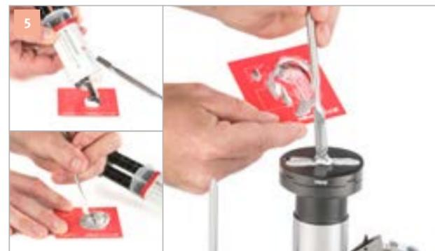
**5** Um eine exakte Haftung zu gewährleisten, den **ADESSOSPLIT® Metallkleber** verwenden (Art.-Nr. 10070). **ADESSOSPLIT® Justiersockelplatte** und Artikulatorunterteil entfetten. Den **ADESSOSPLIT® Metallkleber** gleichmäßig anmischen, bis eine homogene Konsistenz entsteht. Dann mittig auf die **ADESSOSPLIT® Justiersockelplatte** auftragen. Die Verarbeitungszeit beträgt ca. 3 Min.
